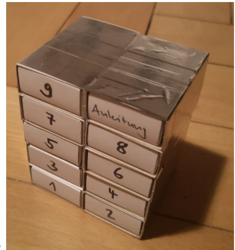
Abb. 4: NIM-Computer aus Zündholzschachteln
