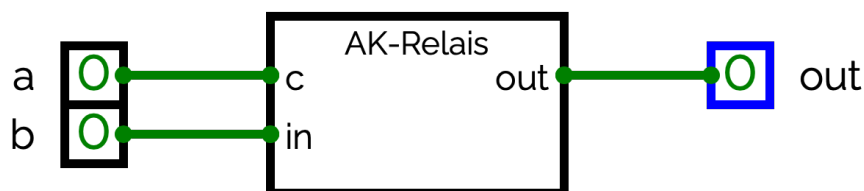
Abbildung 5: Elektronische Schaltung aus einem Relais mit Input a = 0, b = 0
