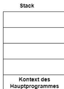
Abbildung 49: Stack unmittelbar vor dem Aufruf der Funktion
